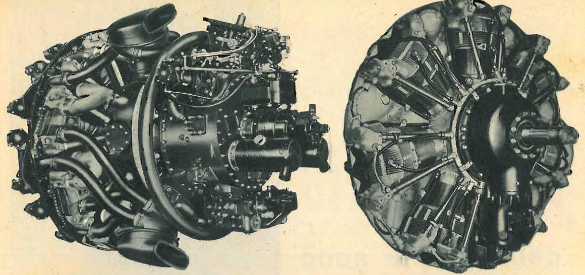
● Il Wright Turbo-Cyclone 18 da 3.250 cav è costituito da un motore a scoppio Cyclone 18 da 2.700 cav nel quale gli scappamenti sono avviati in tre turbine, che trasmettono all'albero centrale
