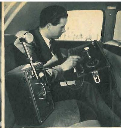
● Uno spettro sonoro, ottenuto mediante un analizzatore che decompone il rumore, consente di precisarne le diverse fonti.
