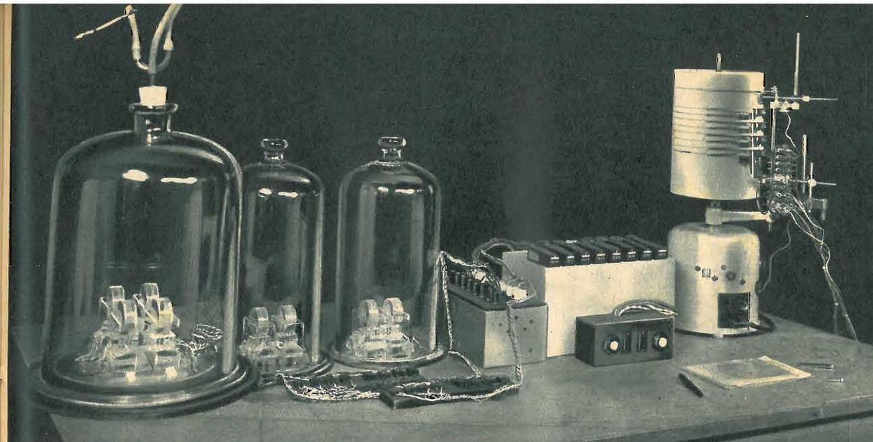
● Le gabbie trasparenti sotto campana (attoografi di Pavan) girano per l'impulso degli insetti che contengono. Le rotazioni sono registrate su un cilindro con un sistema di trasmissione elettrica.
