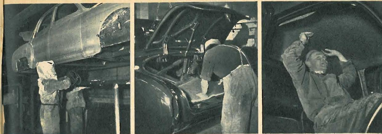
● L'insonorizzazione di una vettura è un'operazione indispensabile alla comodità di chi la usa. Da sinistra a destra: applicazione di un prodotto assorbente sotto il telaio; incollamento di un ri-
