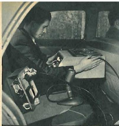
● Il rumore registrato su questa vettura mediante un magnetofono potrà formare oggetto di studio in laboratorio.
