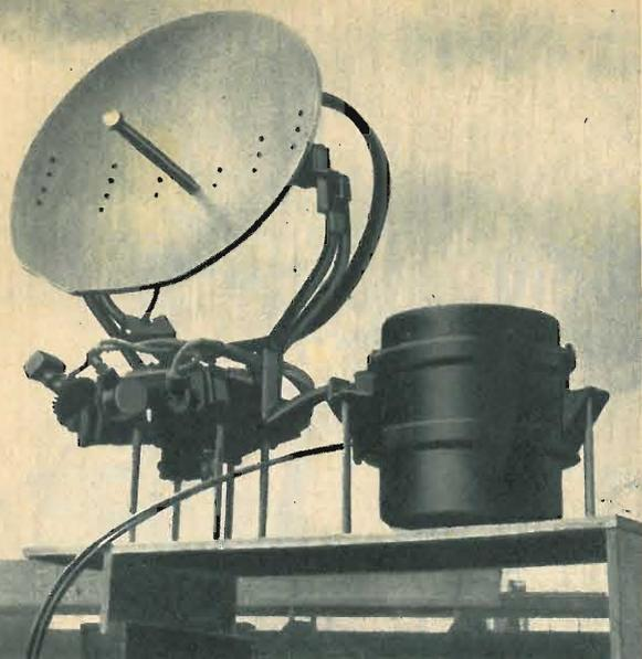
● Antenna paraboloidica di un radar installato in un Osservatorio: l'apparecchio esplora lo spazio ruotando intorno al suo asse orizzontale o verticale.
