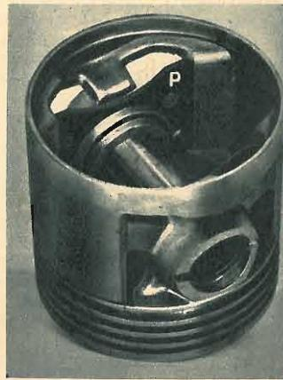
● La placchetta P, dotata di un conveniente coefficiente di dilatazione, è posta in modo che il pistone, leggermente ovale a freddo, divenga a caldo un cilindro perfetto. Si evita così che il pistone batta in testa anche a freddo.
