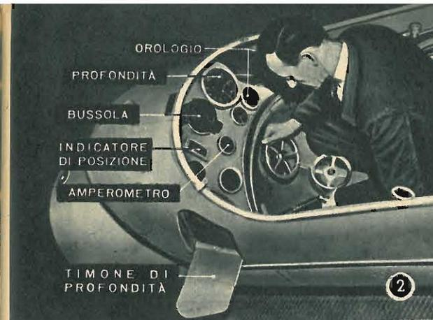
2. Posto di guida di un siluro montato analogo a quello che attaccò la Queen Elizabeth. 3. Due palombari eseguono un esperimento sul siluro montato.
