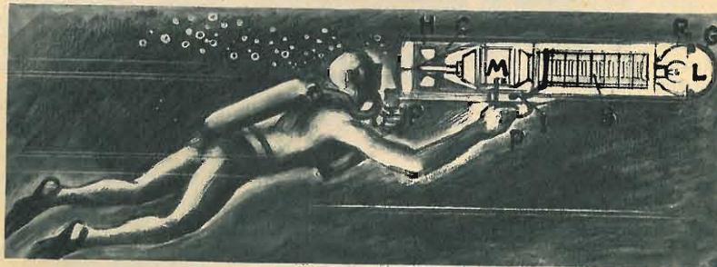
● Il sommergibile individuale. La cabina A, trasparente in P, è provvista di fenditure per la circolazione nell'acqua; BA, accumulatori; B1 e B2: sbarre. Per l'immersione: G: timone; H: elica doppia; motore elettrico; R: in superficie di riscaldamento delle zavorre; S: scandaglio automatico; T: quadro; Z: macchine.
